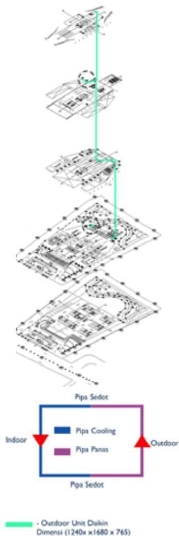
Gambar 2. 24. Isometri sistem tata udara
