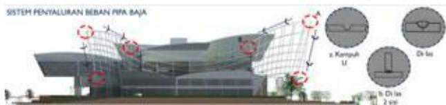
Gambar 2.21. Penyaluran beban sistem struktur las baja pada bangunan
