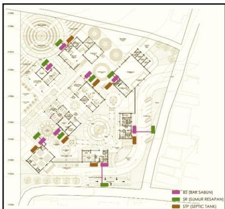
Gambar 2.25. Skema utilitas air kotor dan kotoran
