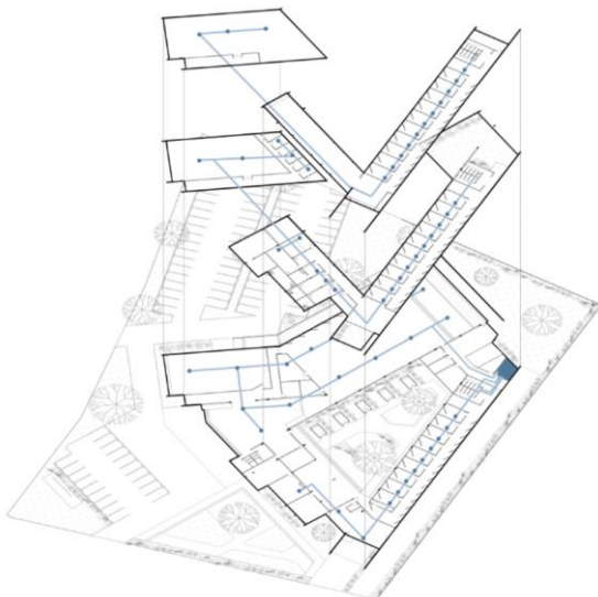
Gambar 2. 20. Isometri Utilitas Tata Udara
