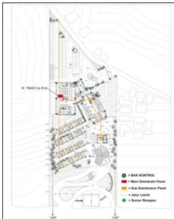
Gambar 2.17 Jalur Utilitas Air Hujan & Listrik
