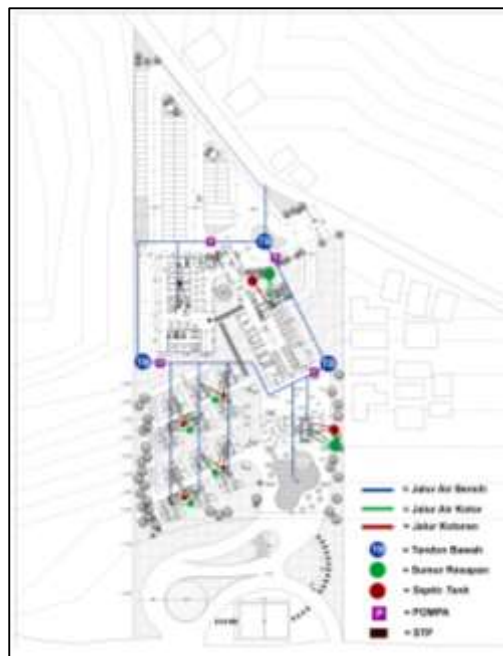
Gambar 2.14 Jalur Utilitas Air bersih & Air Kotor
