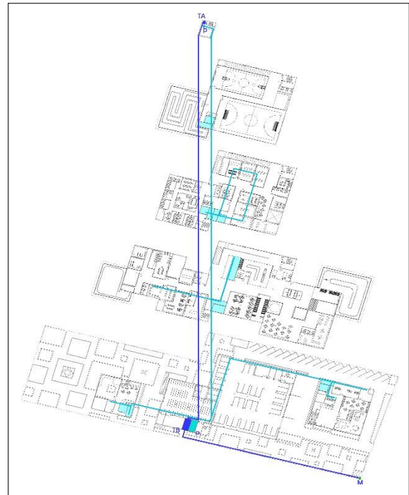
Gambar 2.21. Isometri utilitas air bersih
