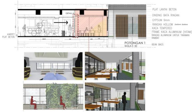
Gambar 2.17. Potongan dan perspektif detail ruang 2.
