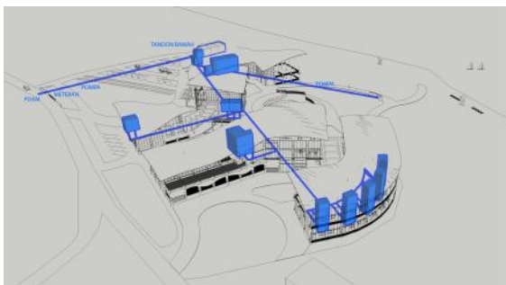
Gambar 2.8 Utilitas Air Bersih
