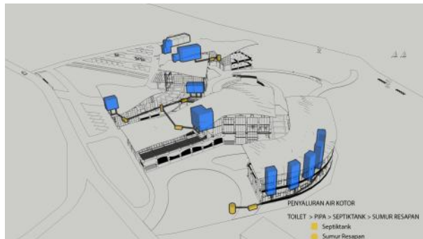
Gambar 2.9 Utilitas Air Kotor
