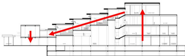
Gambar 2. 10. Potongan dan diagram alur museum secara keseluruhan
