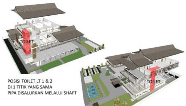
Gambar 2. 24. Skematik Sistem Utilitas Air Bersih
