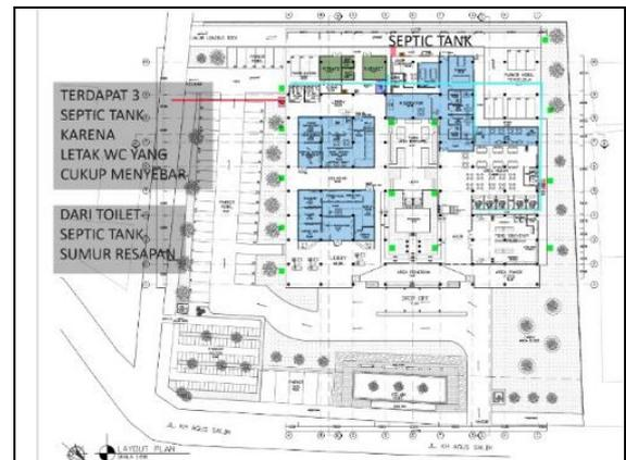
Gambar 2. 25. Letak Septic Tank, Bak Kontrol dan Ruang yang Menggunakan AC (Layout Plan)
