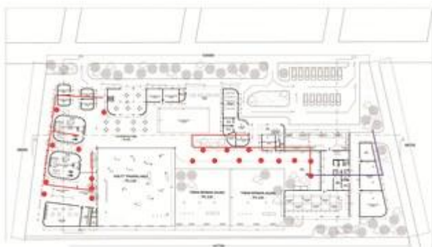
Gambar 2.22. Titik lampu berbahan bakar biogas yang terdapat dalam tapak
