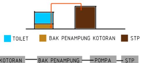
Gambar 2.25.. Isometri utilitas air kotor dan kotoran di basement
