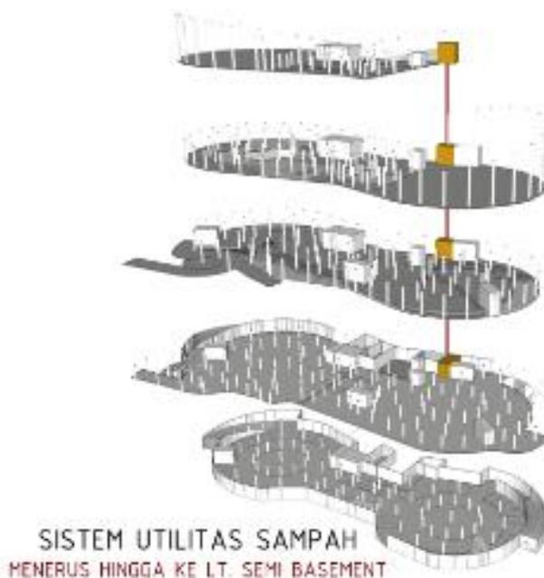
Gambar 2.30. Isometri sistem pembuangan sampah
