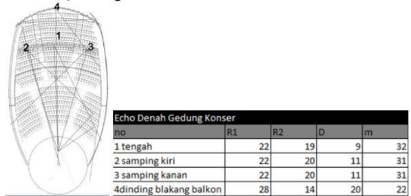
Gambar 2. 16. Denah Sudut Pantul Gedung Konser dan Perhitungan Echo Denah Gedung Konser
