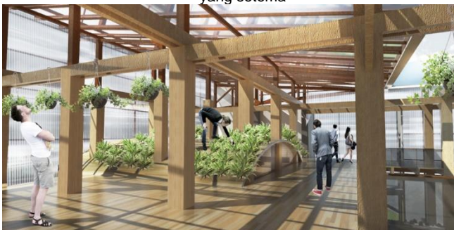
Gambar 2.21. Area Green House pada lantai 5 yang terbentuk dari ruang konferensi dibawahnya, lantai ini menggunakan atap polycarbonate
