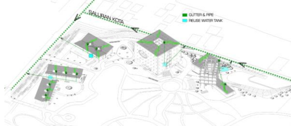
Gambar 2. 34. Isometri utilitas air hujan
