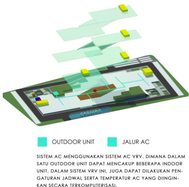
Gambar 2. 26. Isometri sistem tata udara
