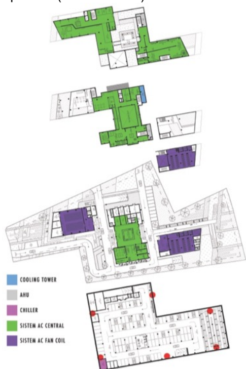
Gambar 2.22. Isometri Sistem Penghawaan Aktif
