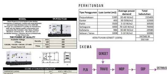
Gambar 2.31. Perhitungan kebutuhan listrik dan skema distribusi listrik pada perpustakaan.
