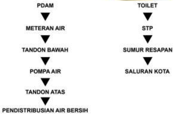
Gambar 2. 2. Isometri utilitas air bersih dan kotor
