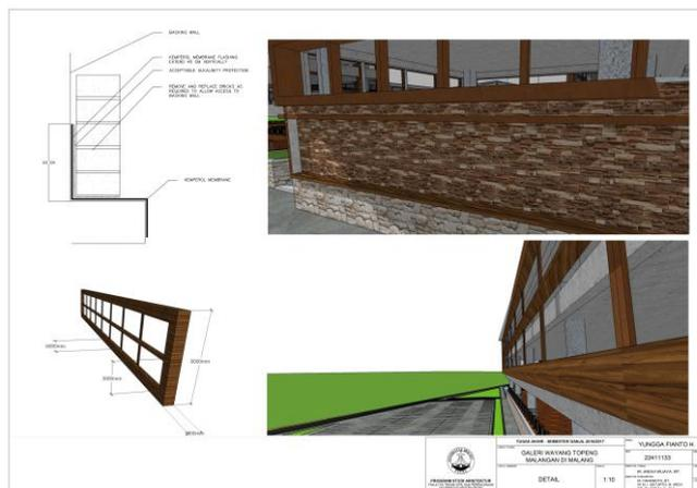
Gambar. 2.13.2. Detail fasad bangunan (dinding bata ekspose dan dinding kayu)
