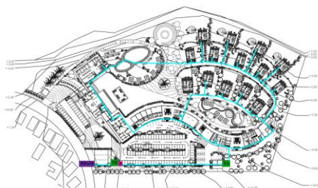
Gambar. 2.23. Skema sistem utilitas air bersih
