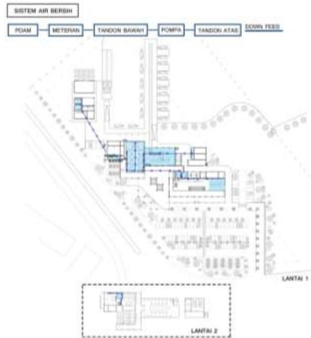
Gambar 2.20. utilitas air bersih
