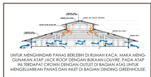
Gambar. 2.12. Konsep Pengudaraan Atap Jackroof
