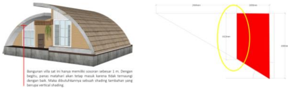
Gambar. 2.10. Perhitungan Shading Vertical Jendela Villa
