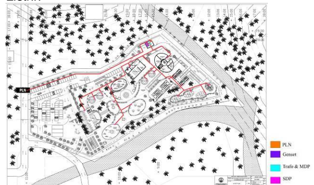
Gambar 2.31 Sistem Utilitas (listrik). Sumber: penulis
