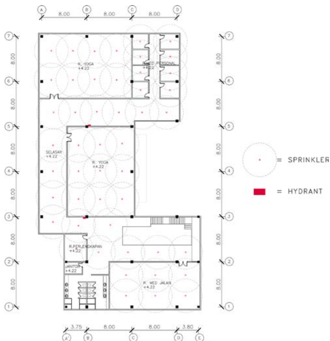
Gambar. 2.26. Denah Sprinkler & Hydrant Massa Meditasi Umum Lt.2
