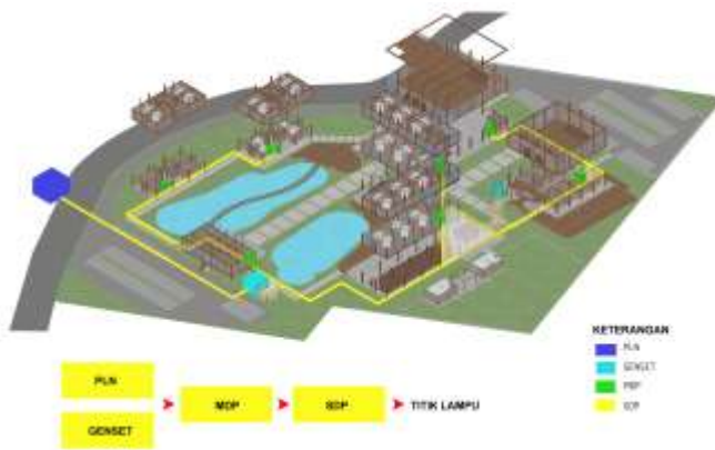
Gambar 2. 3. Isometri sistem kelistrikan
