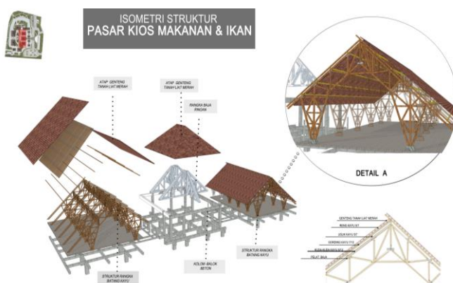
Gambar. 2.27. Pola Stuktur Rangka Batang Kayu Sumber: Penulis
