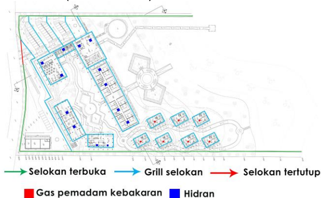
Gambar 2. 27. Skema utilitas air hujan dan kebakaran
