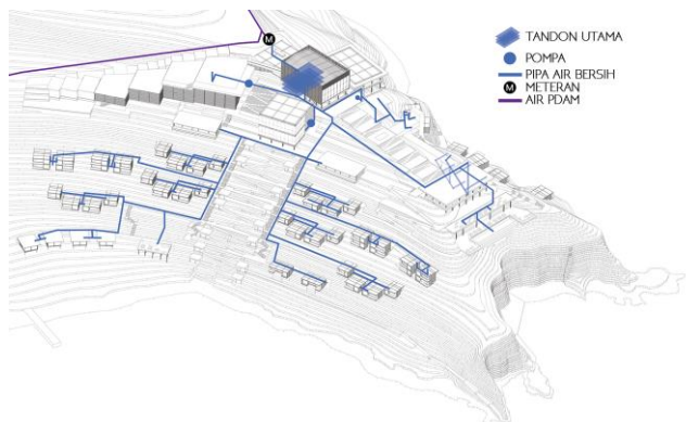
Gambar 2.35 Sistem utilitas air bersih
