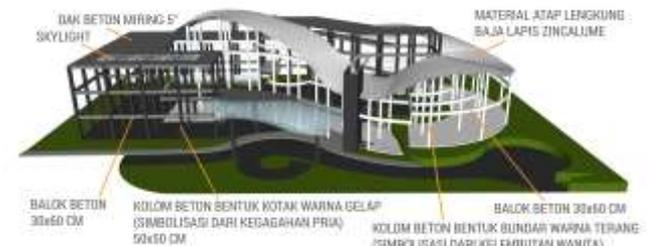
Gambar 2. 14. Aksonometri struktur
