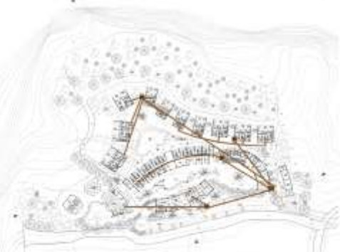
Gambar. 2.21 Skema Distribusi Air Kotor dan Kotoran. Sumber: Penulis
