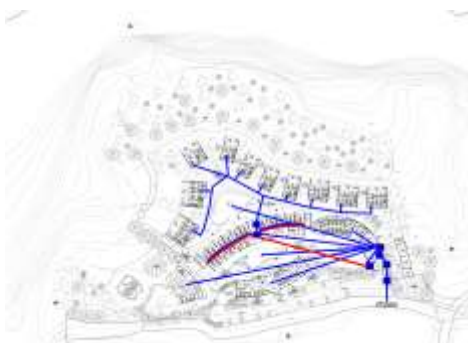
Gambar. 2.20 Skema Distribusi Air bersih dan Air Panas. Sumber: Penulis
