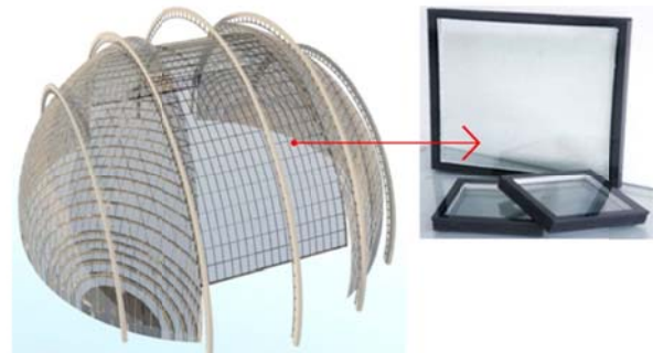
Gambar 2.22. Kaca Low-E pada Dome
