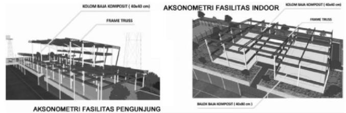
Gambar 2.12 Aksonometri struktur bangunan pada fasilitas pelatihan
