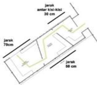
Gambar 2.10 Kisi- Kisi Denah Penempatan kisi kisi serta pola denah yang memungkinkan adanya hubungan antara sirkulasi dan akomodasi mata terhadap gelap terang.
