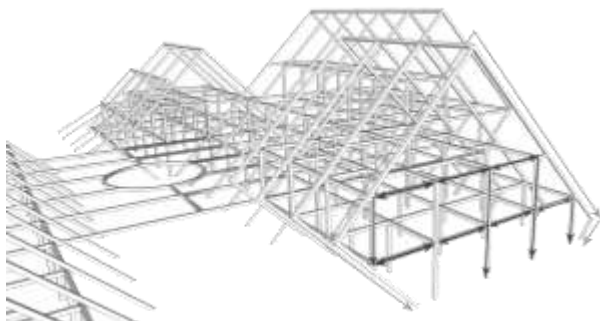
Gambar 1.18 Sistem Penyaluran Beban Pada Massa Kutai
