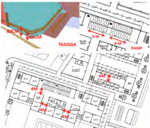
Gambar 2.16. Ukuran-ukuran koridor, ramp dan railing pada bangunan
