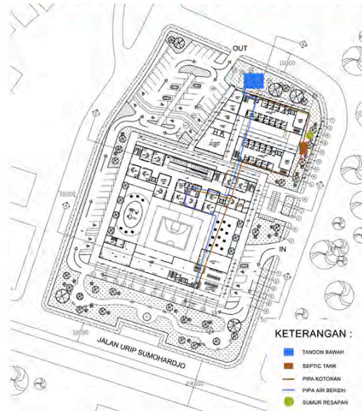
Gambar 2.23. Sistem utilitas air bersih dan air kotor
