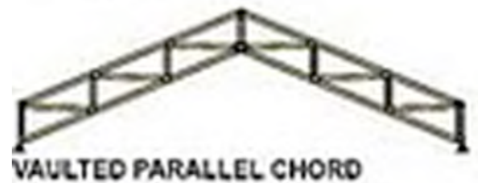
Gambar 2.12. Bentuk Kuda-Kuda yang digunakan
