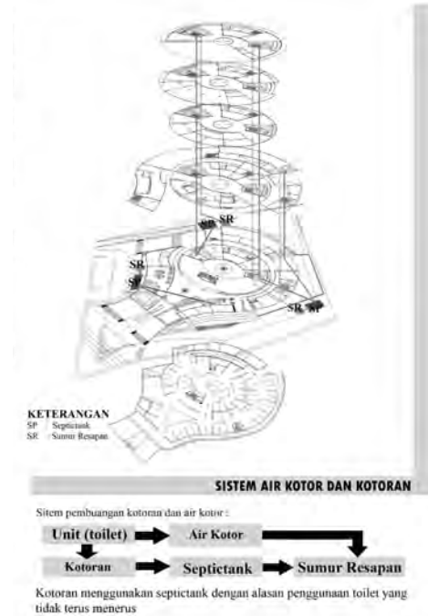
Gambar 2.23 Sistem Utilitas Air Kotor dan Kotoran
