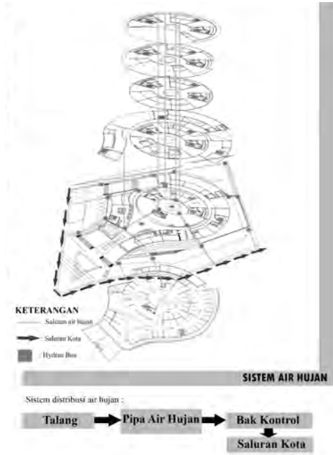
Gambar 2.25 Sistem Utilitas Air Hujan
