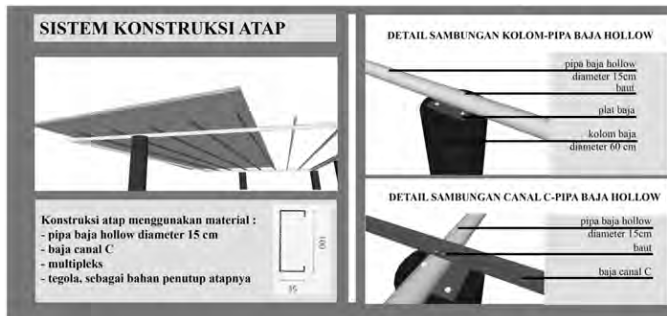
Gambar 2.21 Sistem Konstruksi Atap Bangunan
