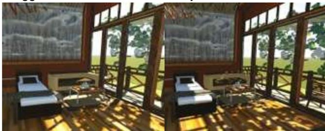
Gambar. 2.21 Pencahayaan Alami Dalam Kamar Penghawaan dalam kamar menggunakan penghawaan pasif dimana udara dapat masuk melalui kisi-kisi kayu yang terdapat di atas teras dan keluar melalui kisi-kisi yang berada di atas pintu masuk kamar, sehingga terjadi cross ventilasi.
