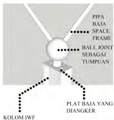
Gambar 2.21 Detail Tumpuan Pada Atap Hall Utama
