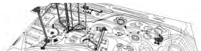
Gambar 2.15 Axonometri Distribusi Air Bersih
