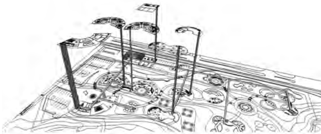
Gambar 2.17 Axonometri Distribusi Listrik
