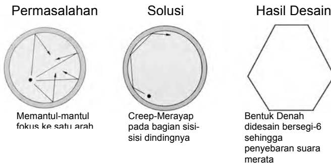
Gambar 2.40 Studi Pemantulan Suara Terhadap Bentuk Denah
