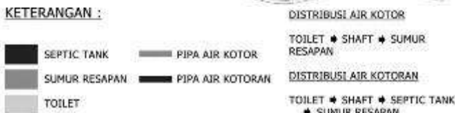
Gambar 2.27 Sistem Utilitas Air Kotor dan Kotoran
