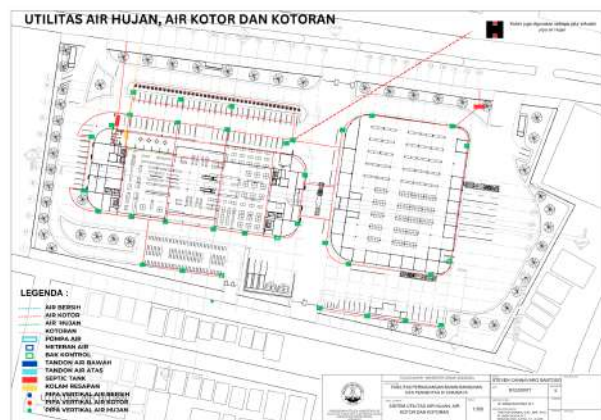
Gambar 5.3. Utilitas Air Kotor dan Hujan Layout Plan , sumber: Ilustrasi Pribadi, 2024
