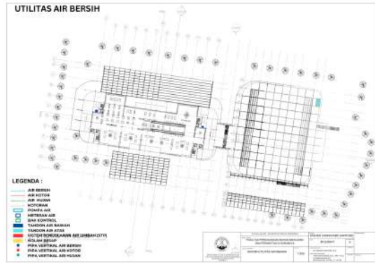
Gambar 5.2. Utilitas Air Bersih Lantai 2, sumber: Ilustrasi Pribadi, 2024
