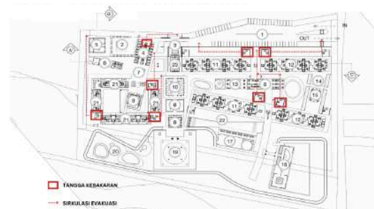
Gambar 1.14. Skema Utilitas Kebakaran dan Evakuasi
