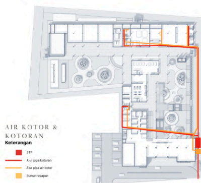
Gambar 4.3. Sistem Utilitas Air Kotor dan Kotoran
