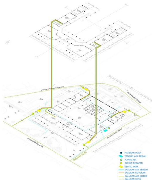
Gambar 5.1. Isometri dan skema sistem utilitas air
