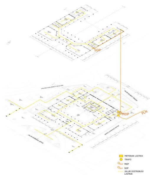
Gambar 5.4. Isometri dan skema sistem utilitas listrik
