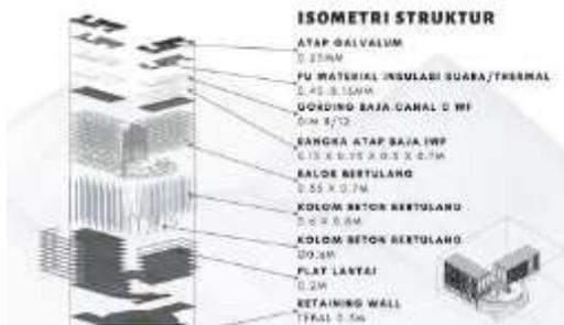
Gambar 4.1. Sistem Struktur Bangunan
