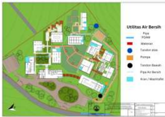
Gambar 2. 15. Diagram Utilitas Air bersih, (Sumber : Ilustrasi Pribadi)
