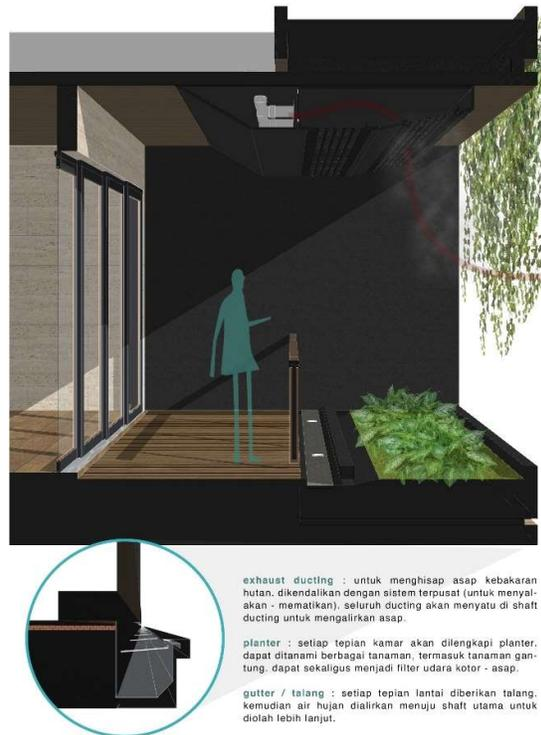
*exhaust ducting* : untuk menghisap asap kebakaran hutan, dikendalikan dengan sistem terpusat (untuk menyala- akan - mematikan), seluruh ducting akan menyatu di shaft ducting untuk mengalirkan asap.
