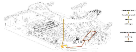
Gambar 5.5. Skema Utilitas Air Kotor & Kotoran
